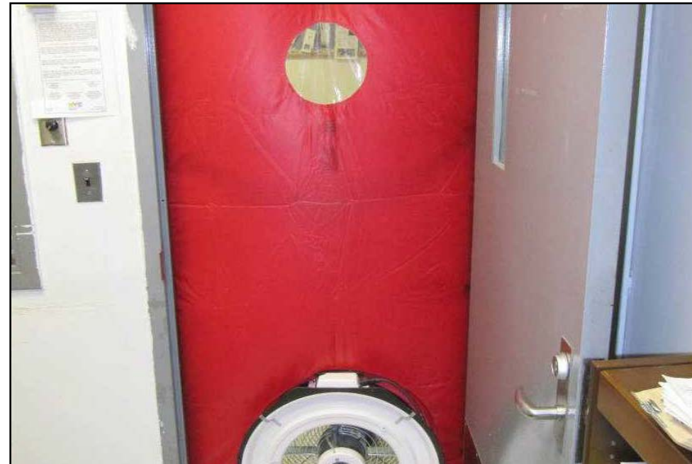
Blower Door Test
